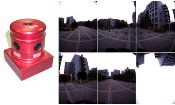
図6 全方位型マルチカメラシステム Ladybug と撮影された全方位画像
