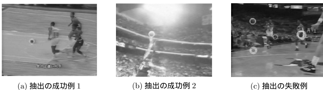
図 9 エッジ検出と円形 Hough 変換によるバスケットボールの抽出 [39]
