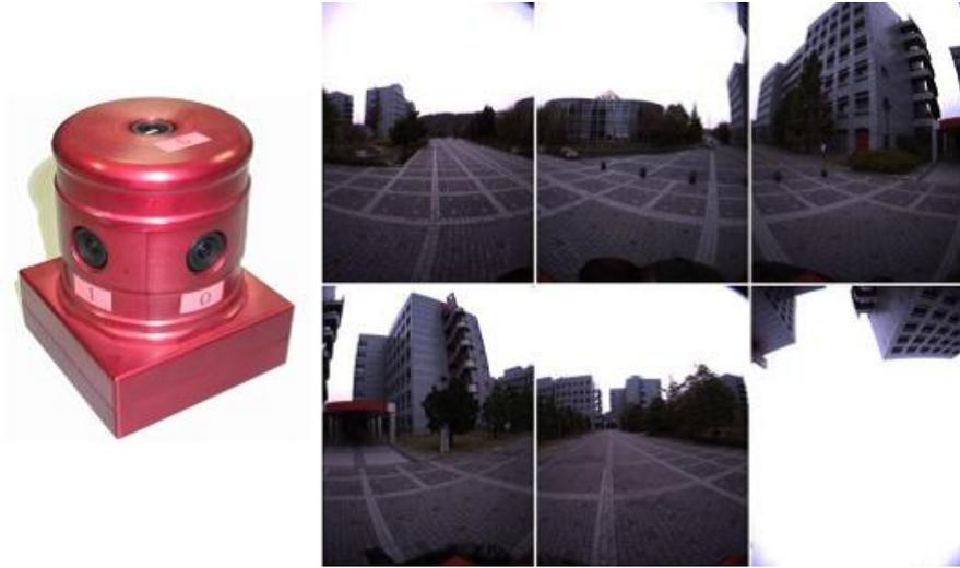
図 12 全方位型マルチカメラシステム Ladybug と撮影された全方位画像
