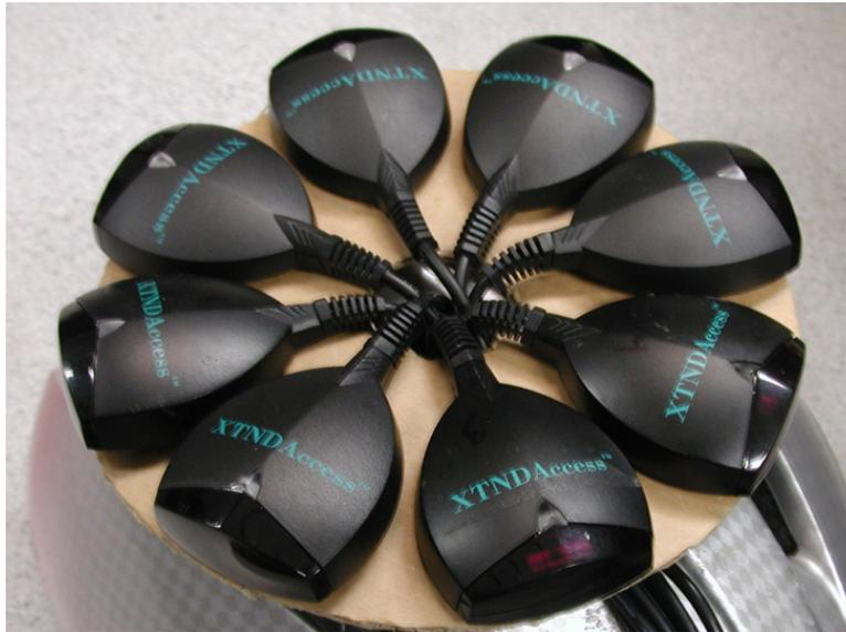
図 1 Hallaway らの手法で用いる赤外線受光体 [7]
