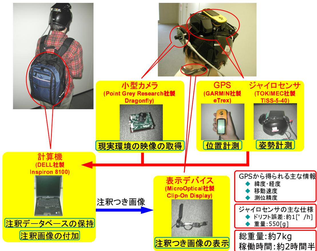
図 6 ウェアラブル型拡張現実感システムの構成と外観
