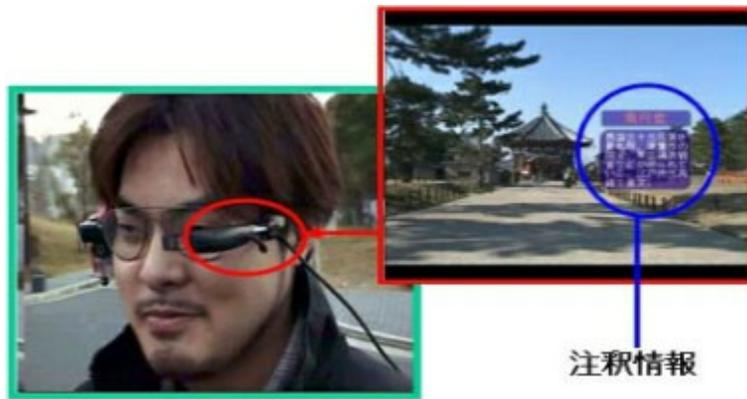
図 1 ウェアラブル拡張現実感の例
