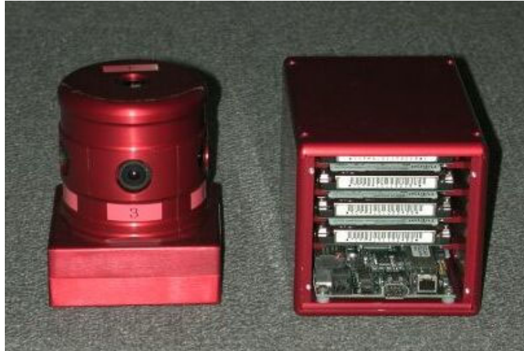
図 3 Ladybug のカメラヘッド (左) と蓄積ユニット (右)
