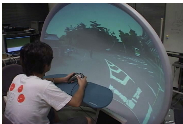
図 31 球面ディスプレイを用いたテレプレゼンスシステムの外観
