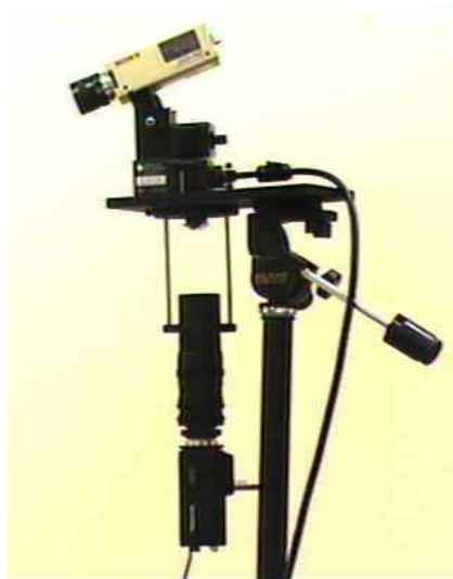
図 3 全方位画像センサと回転カメラを組み合わせたシステム [19]
