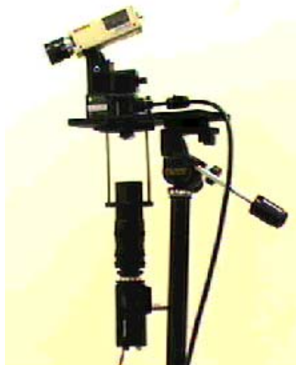
図 1 全方位画像センサとパン/チルト/ズームカメラによるシステム
