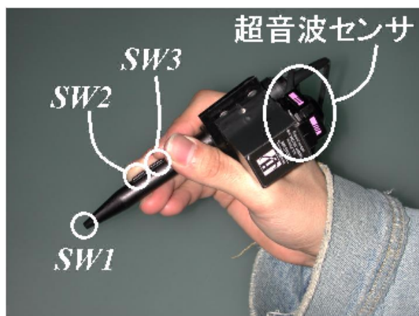
図 15 ライトペンと超音波センサを組み合わせたペン型デバイス
