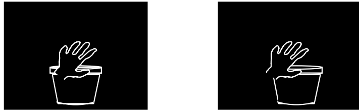
(1) sobel フィルタを用いてエッジ検出
