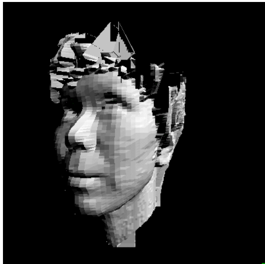
図 7 距離データのみを用いた 3 次元形状表現
