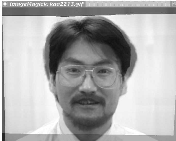
図 28 2 枚の画像間で行なわれるモーフィングの例：画像 A(35%)+画像 B(65%)
