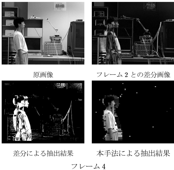
図 4.5 移動物体の抽出結果 (実験 5: カメラ視点の前方への平行移動)
