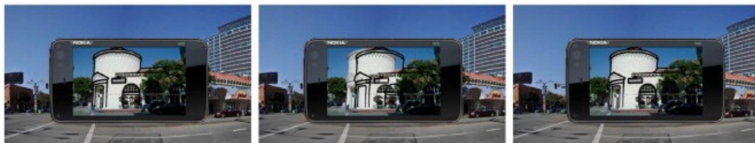
図 1 事前生成型 AR[11] の提示映像比較 (左：理想重畳画像，中央：センサベース AR，右：事前生成型 AR)
