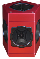
図 13: 全方位マルチカメラシステム (Ladybug3)
