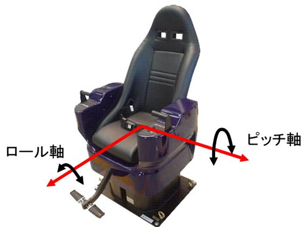
図 42 提案手法で用いる低自由度モーションベース
