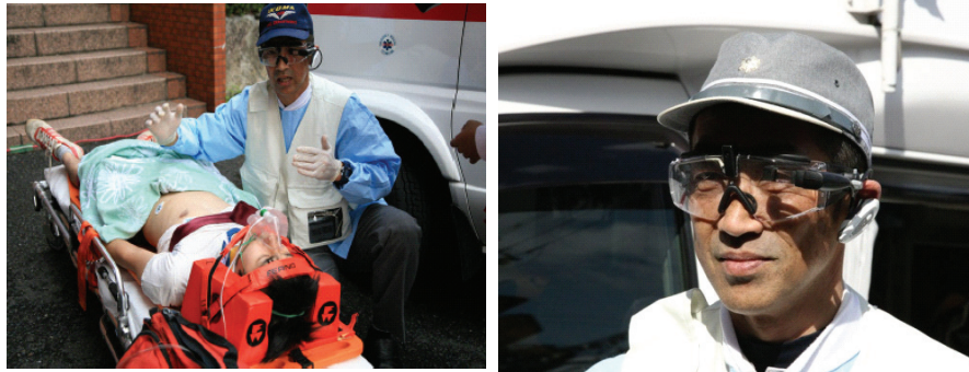
(a) ウェアラブルコンピュータを装着した救急隊員 (b) カメラとHMDが実装されたゴーグル
