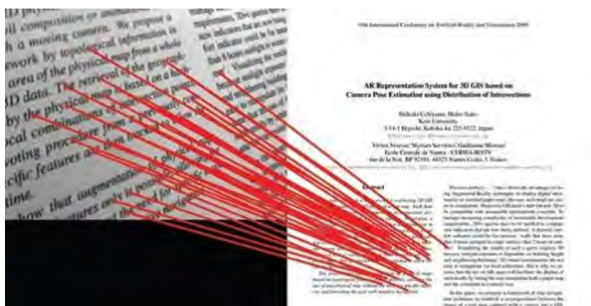
図 8 文字の重心から算出可能な特徴量を用いた紙面の入力画像の対応付け [27]
