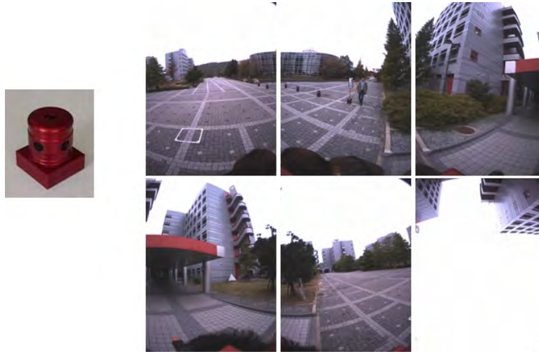
図 20 全方位型マルチカメラシステムと全方位画像の1フレーム
