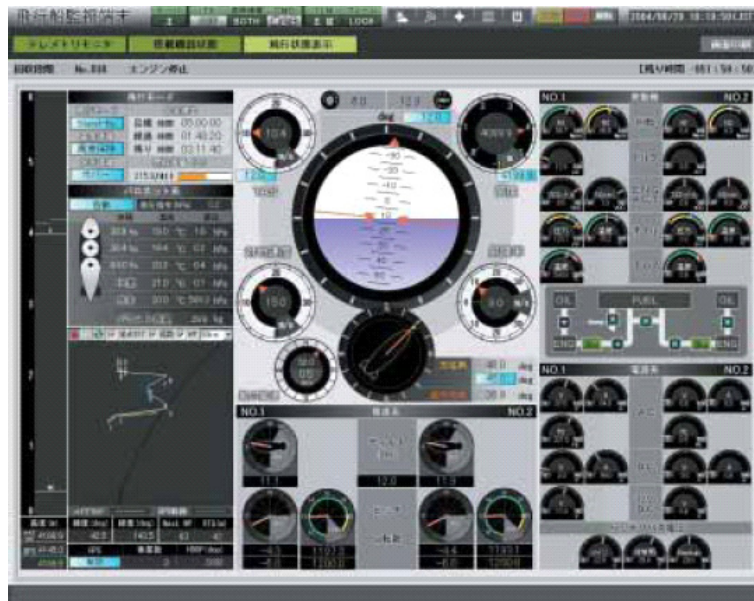
図 11 航行情報の提示による操縦インタフェース (勝山ら [26])
