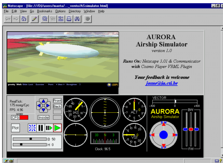
図 9 航行情報の提示による操縦インタフェース (Ramos ら [4])
