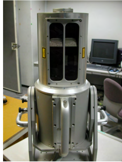
図 9 レーザレンジファインダの例 (左: Leica 社製 TCR1105XR, 右: Riegl 社製 LMS-Z360)
