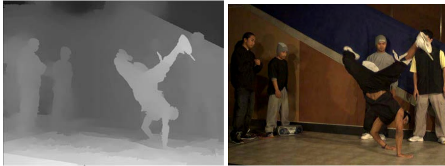
図 11 セグメンテーションベースドステレオにより推定された奥行き（左）と自由視点画像例（右） [ZKU+04]
