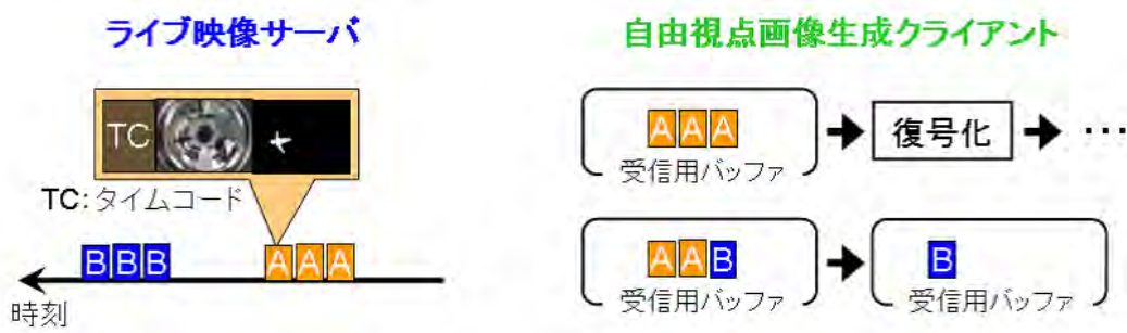
図 65 ライブ映像サーバでのタイムコード付加と自由視点画像生成クライアントでの受信処理
