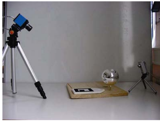
図 6 鏡面球の撮影に専用のカメラを用いた AR システムの外観
