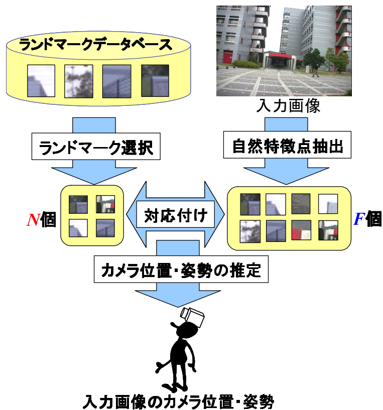
図 7 ランドマークデータベースを用いたカメラ位置・姿勢推定（オンライン処理）
