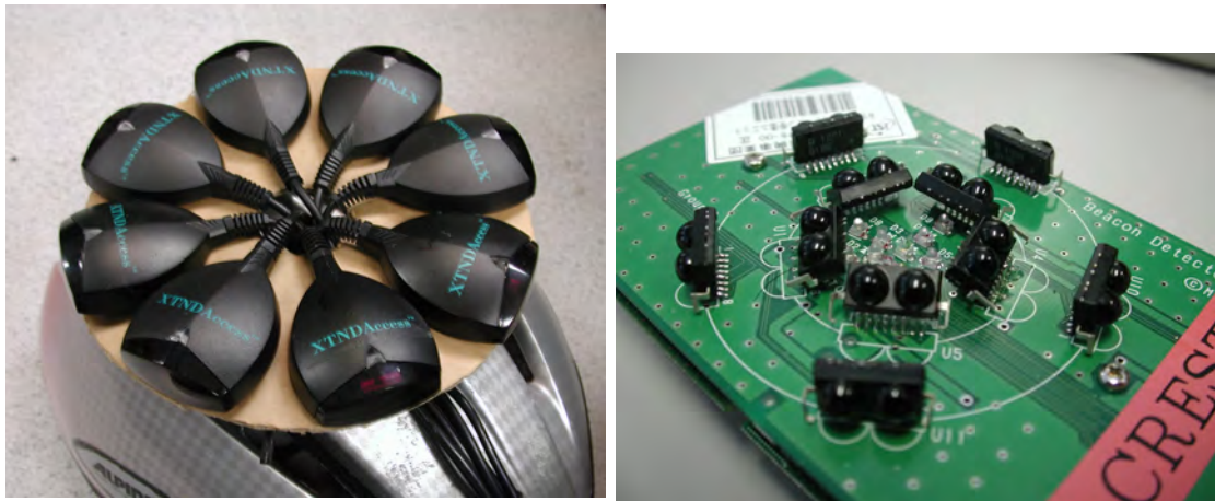
図 18 Hallaway ら [HHF03] の赤外線受 図 19 神原ら [神原 04b] の赤外線受光体 光体
